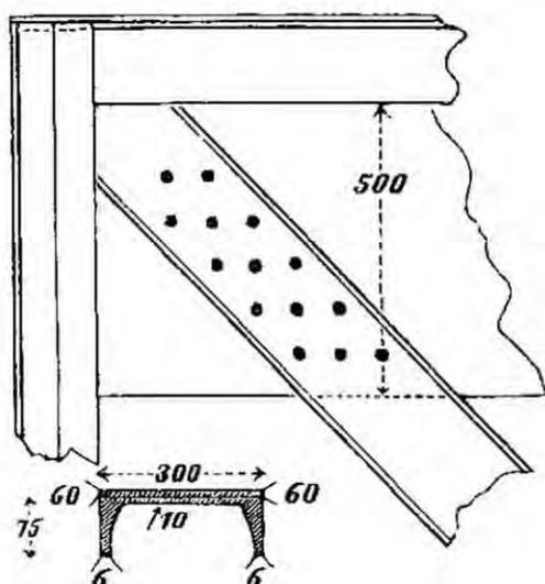
Remachaduras de los diagonales núms. 11 i 39 de los tramos de 60 m. i núms. 3 i 31 de los tramos de 50 m.
