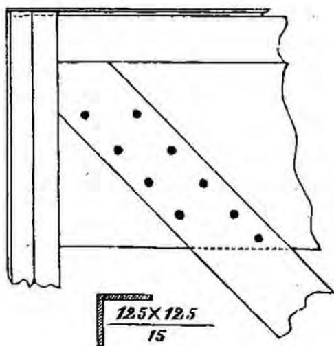
Remachaduras de los diagonales núms. 19 i 31 de los tramos de 60 m. i núms. 11 i 23 de los tramos de 50 m.
