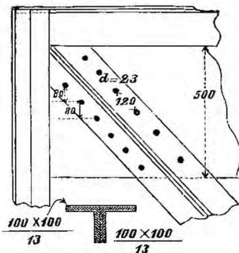
Remachaduras de los diagonales núms. 15 i 35 de los tramos de 60 m. i núms. 7 i 27 de los tramos de 50 m.
