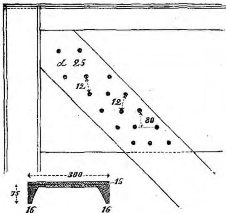
Remachaduras de los diagonales núms. 3 i 47 de los tramos de 60 m. i de la diagonal núm. 39 de los tramos de 50 m.
