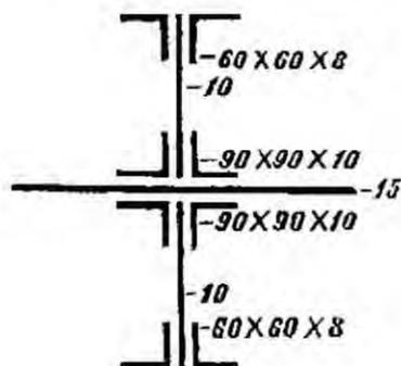
Remachaduras de los montantes núms. 5 i 45 de los tramos de 60 m. i del montante núm. 37 de los tramos de 50 m.
