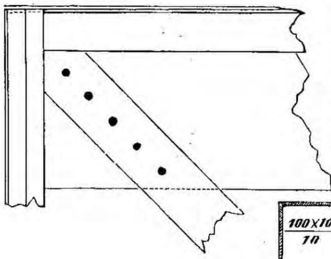
Remachaduras de las diagonales núms. 23 i 27 de los tramos de 60 m. i de los núms. 15 i 19 de los tramos de 50 m.
