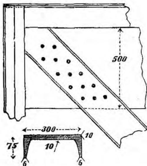
Remachaduras de los diagonales núms. 7 i 43 de los tramos de 60 m. i núm. 35 de los tramos de 50 m.
