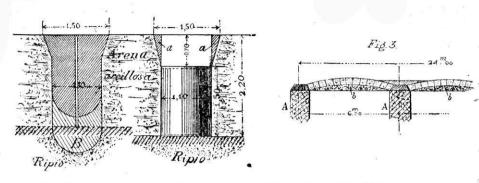
operacion fácil, a consecuencia del terreno removido en el fondo) miéntras que un obrero entraba al cilindro i estraia a pala la tierra que otro la depositaba a mas distancia del foso. La escavacion en el foso debia concluirse ántes de media hora, porque entónces volvia a brotar el agua. Algunos escombros i tierra suelta se estraian junto con el agua por medio de bombas.
