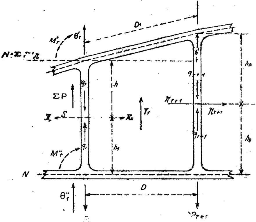
Lo cortamos en dos trozos por las secciones  $S_r$  y  $S_{r+1}$  a nivel de los puntos de inflexión sobre los montantes.
