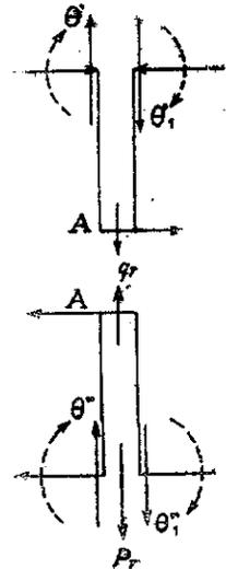
Aislemos un trozo superior del montante N.º r por una sección horizontal A y dos secciones verticales inmediatamente a derecha e izquierda. Tenemos la sollicitación dada por la fig. 4 y la ecuación estática de las componentes verticales nos da:
