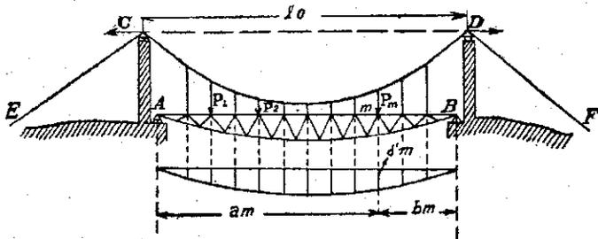
Basados en este teorema se pueden encontrar las expresiones de las magnitudes  $X$ . Supongamos el caso de los puentes colgantes. Hagamos actuar sobre la viga atiesadora un sistema de cargas  $P$  en la hipótesis que se hayan cortado los fiadores  $CE$  y  $DF$  la viga será simplemente apoyada y las reacciones de apoyo son:
