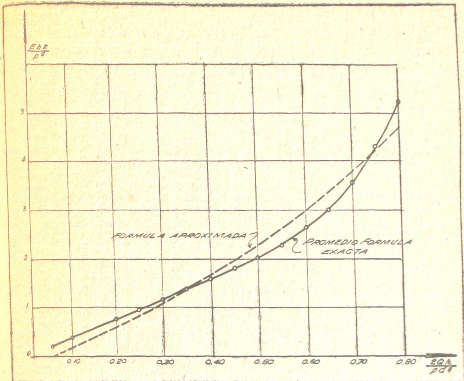
Siendo  $\frac{2Qh}{pd^2} \geq 0,333$  la máxima fatiga de compresión es en la base según 2) y 7)
