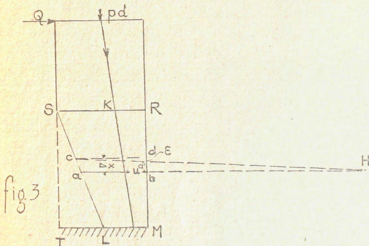
Tenemos de la semejanza de los triángulos  $c-a-H$  y  $c-d-d'$  siendo  $dd' = \xi$  (acortamiento de la fibra  $db$  por efecto de la fatiga de compresión) y  $a-H = \rho$  (radio de curvatura de la elástica)
